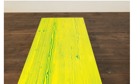
Nach weiteren 24 Stunden Trockenzeit ist das neu gestaltete Möbelstück einsatzbereit. Ein Endanstrich mit dem Hartwachs-Öl oder dem TopOil schützt gegen Abrieb, Feuchtigkeit und Schmutz. (Foto: Osmo)
