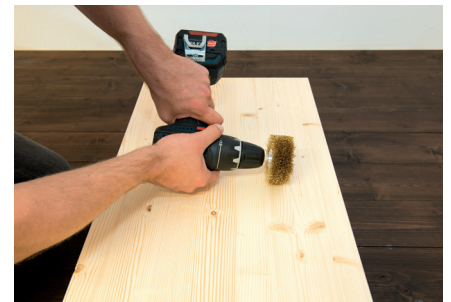
Im ersten Schritt wird die Leimholzplatte mithilfe einer Bohrmaschine mit Bürstenaufsatz strukturiert. (Foto: Osmo)
